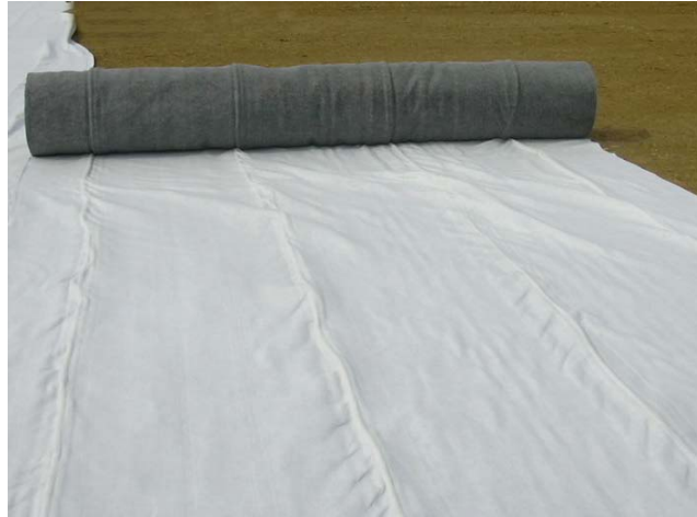
Figures 1 et 2. Description du géocomposite de filtration et drainage
